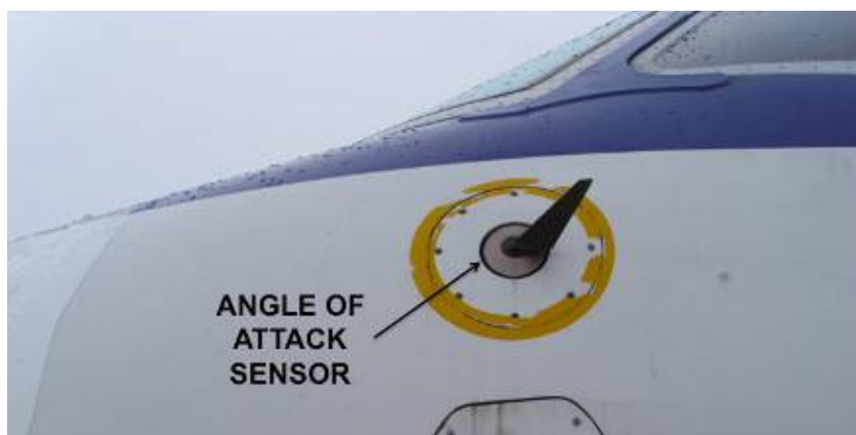
Sonde (ou capteur) d'incidence (AoA - angle of attack)
